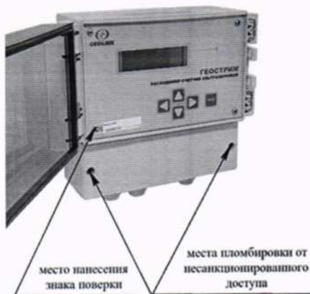
Рисунок 5 – Схема пломбировки от несанкционированного доступа, обозначение места нанесения знака поверки
