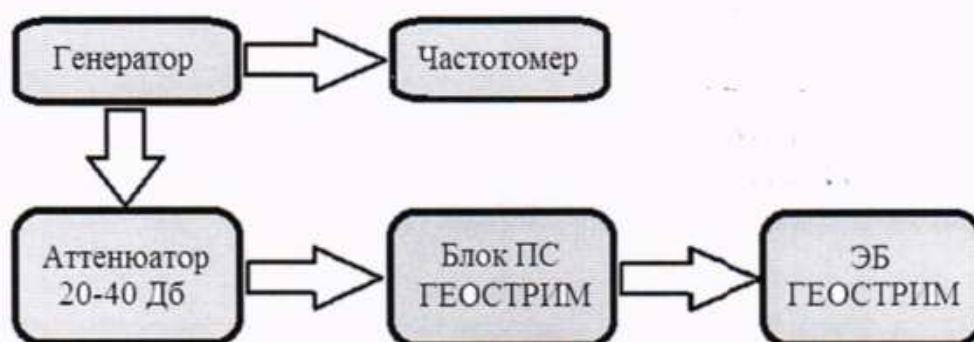
Рисунок 2 – Схема функциональная соединения приборов для имитационной проверки
