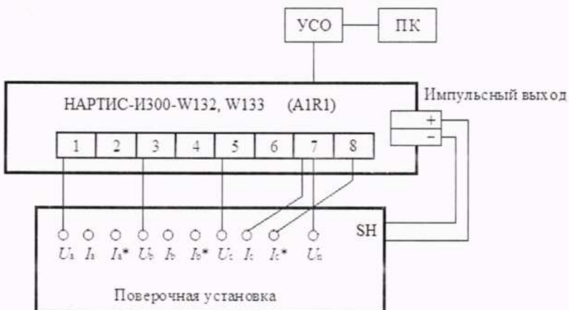
Рисунок Б.8 – Схема подключения счетчиков с типом корпуса W132, W133 непосредственного включения к поверочной установке и к ПК (для определения погрешности измерений тока нейтрали)
