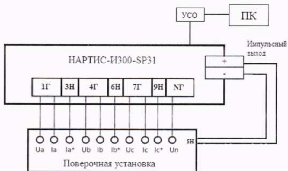
Рисунок Б.1 – Схема подключения блоков измерительных с типом корпуса SP31 к поверочной установке и к ПК
