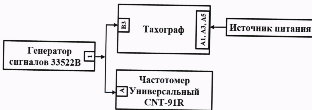
Рисунок 2 – Схема проведения измерений при определении абсолютной погрешности измерений интервала времени и абсолютной инструментальной погрешности измерений пройденного пути
