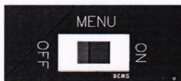
Рисунок А.3 – Вид положения переключателя для входа в режим настроек на контроллере Atlas Master 100Ex L (201)
