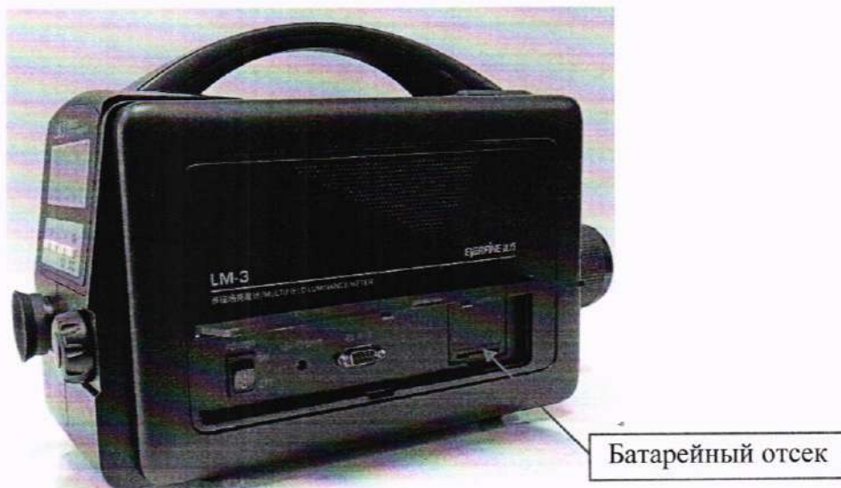
Рисунок 1 – Общий вид яркомеров LM-3
