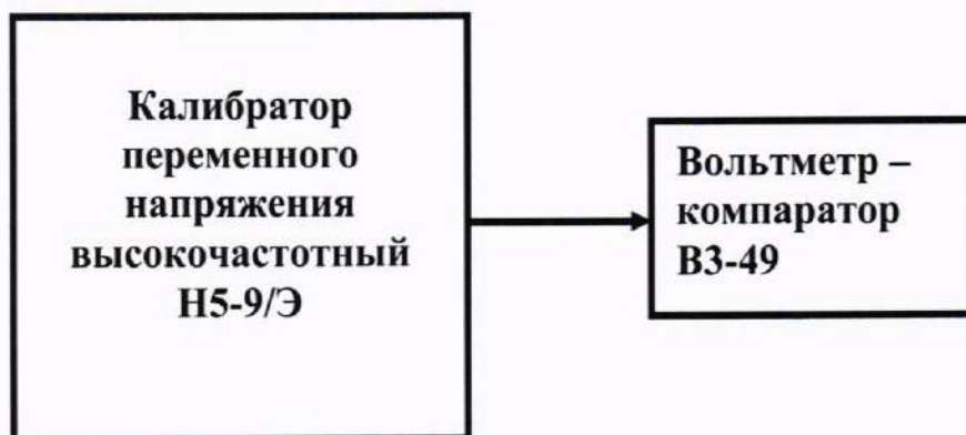
Рисунок 1 – Схема соединения приборов при определении метрологических характеристик калибратора
