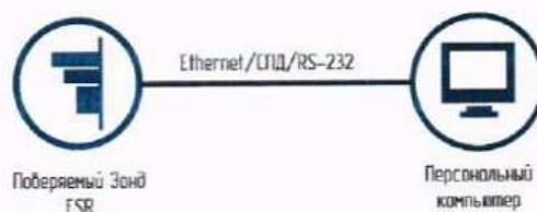
Рисунок 1 – Схема измерений для настройки сетевого интерфейса Зонда ESR KMUT
