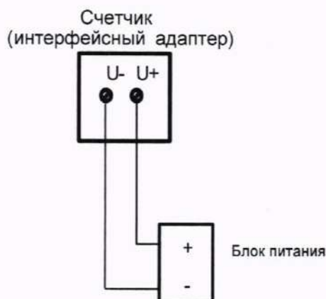
Рисунок 2 – схема подключения электропитания счетчика
