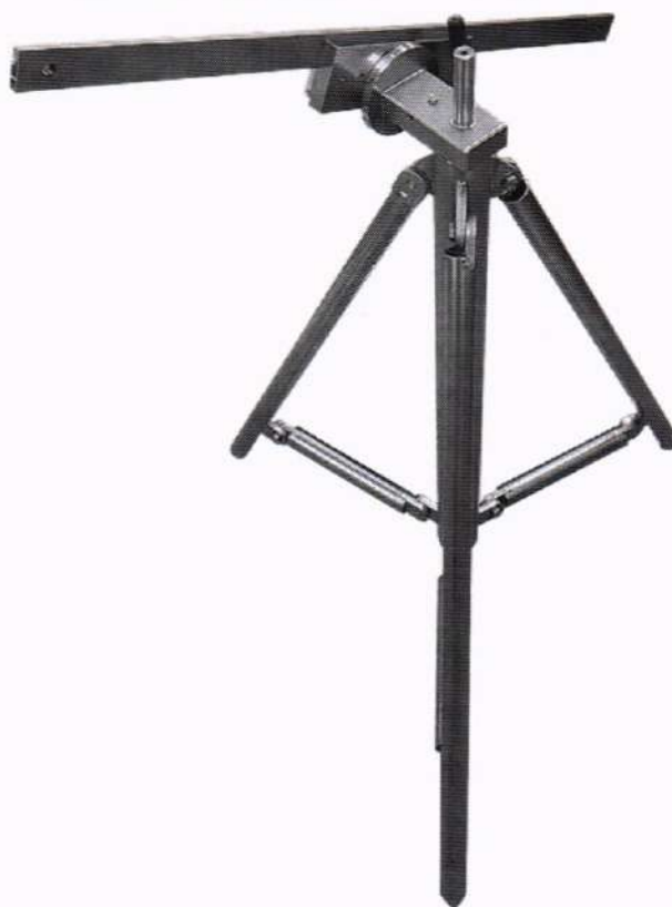
Рисунок А.1 – приспособление для фиксации мер длины концевых плоскопараллельных
