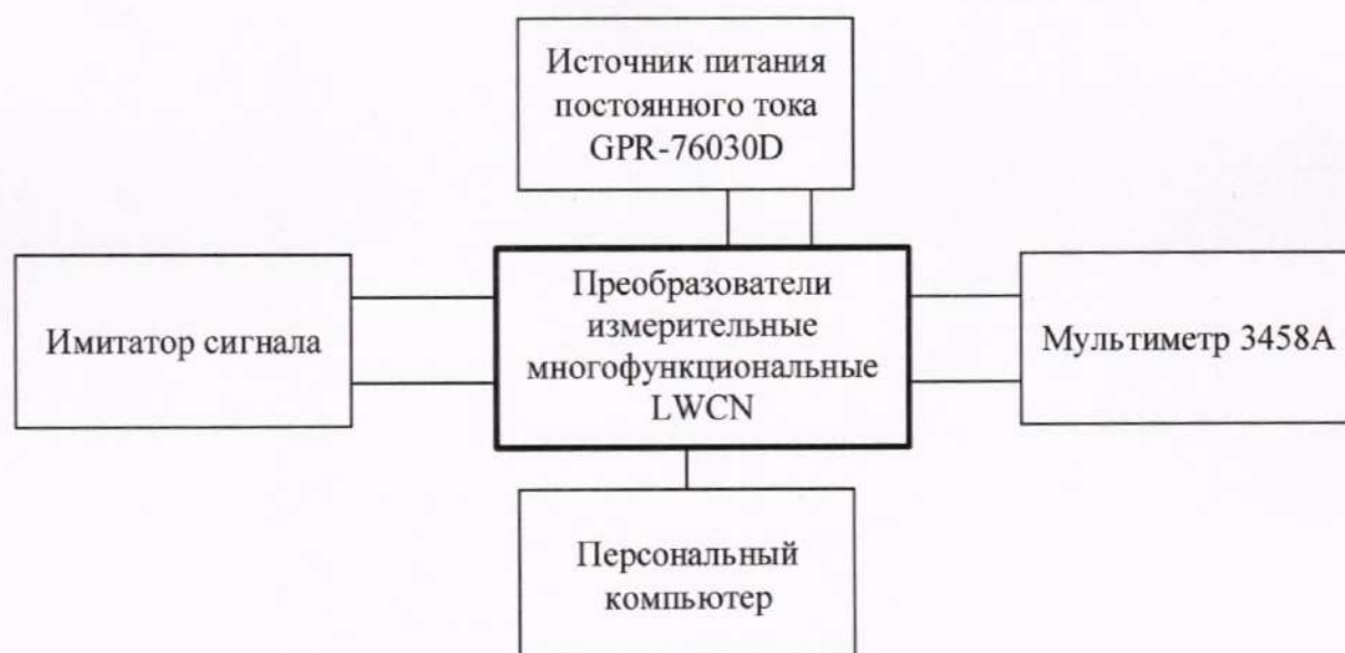
Рисунок А.1 – Схема определения основной приведенной (к верхнему пределу диапазона входного сигнала) погрешности преобразователя Имитатор сигналов - Калибратор многофункциональный и коммуникатор BEAMEX MC6 (-R)
