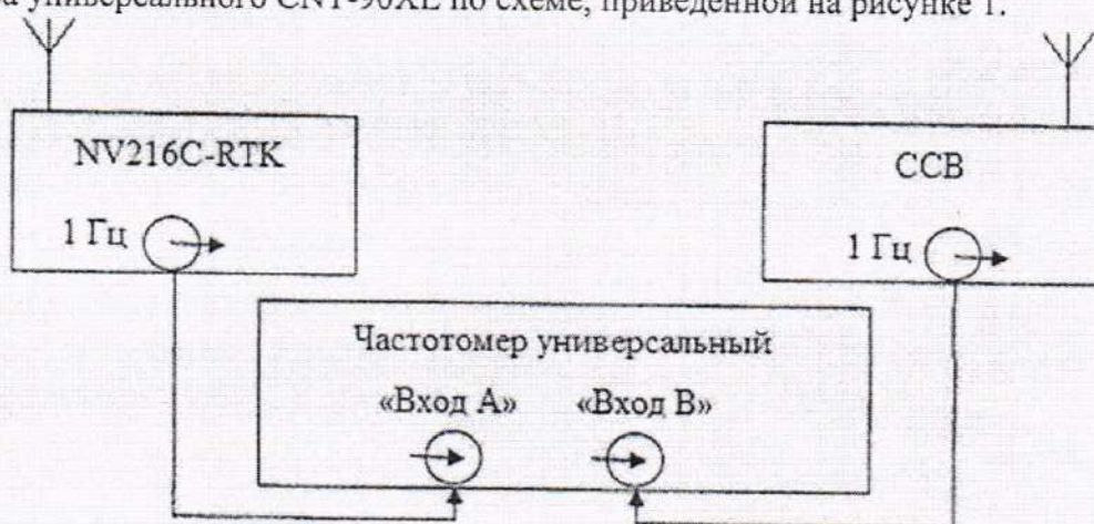
Рисунок 1 – Схема определения абсолютной погрешности привязки переднего фронта выходного импульса 1 Гц ССВ к шкале времени UTC(SU)
