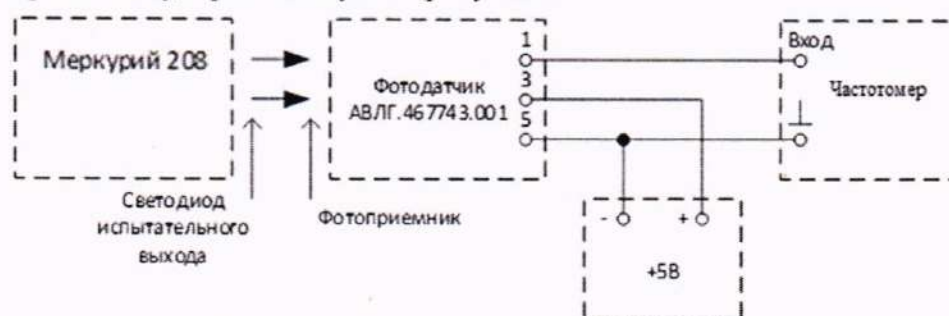
Рисунок 2 – Схема подключения счетчика для определения хода часов
