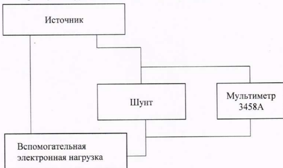
Рисунок 2 – Схема подключения источника при абсолютной погрешности воспроизведений силы постоянного тока
