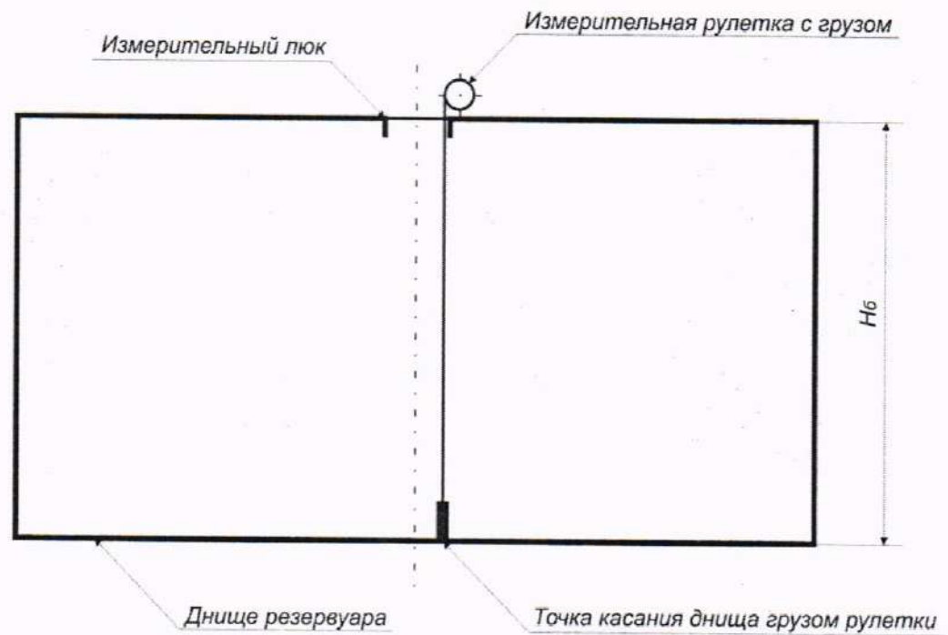
Рисунок А.1 – Схема измерения базовой высоты резервуара и эталонного расстояния уровнемера
