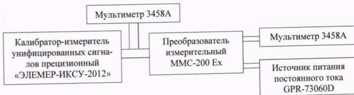
Рисунок 2 – Схема подключения для определения основной абсолютной погрешности преобразований входного сигнала от преобразователей термоэлектрических в выходной сигнал
