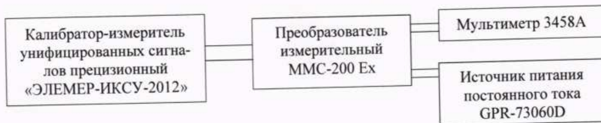
Рисунок 3 – Схема подключения для определения основной абсолютной погрешности преобразований входного сигнала в виде напряжения постоянного тока в выходной сигнал
