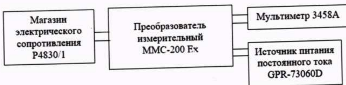
Рисунок 1 – Схема подключения для определения абсолютной погрешности преобразований входного сигнала от термопреобразователей сопротивления в выходной сигнал
