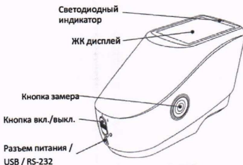
Рисунок 3 - Схематическое изображение модификации SLPQ8DA с обозначением основных элементов конструкции и органов управления
