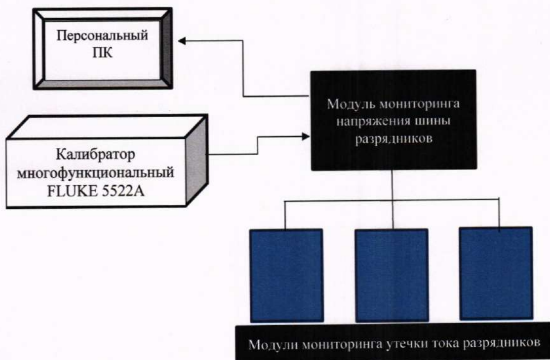
Рисунок 2. Схема подключения устройства онлайн мониторинга OSA3060 для проведения поверки п.п.10.5
