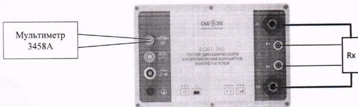
Рисунок 1 – Схема определения относительной основной погрешности преобразований электрического сопротивления
