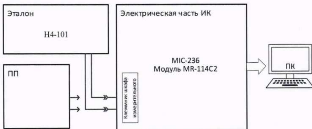
Рисунок 29 – Схема поверки ИК силы переменного тока
