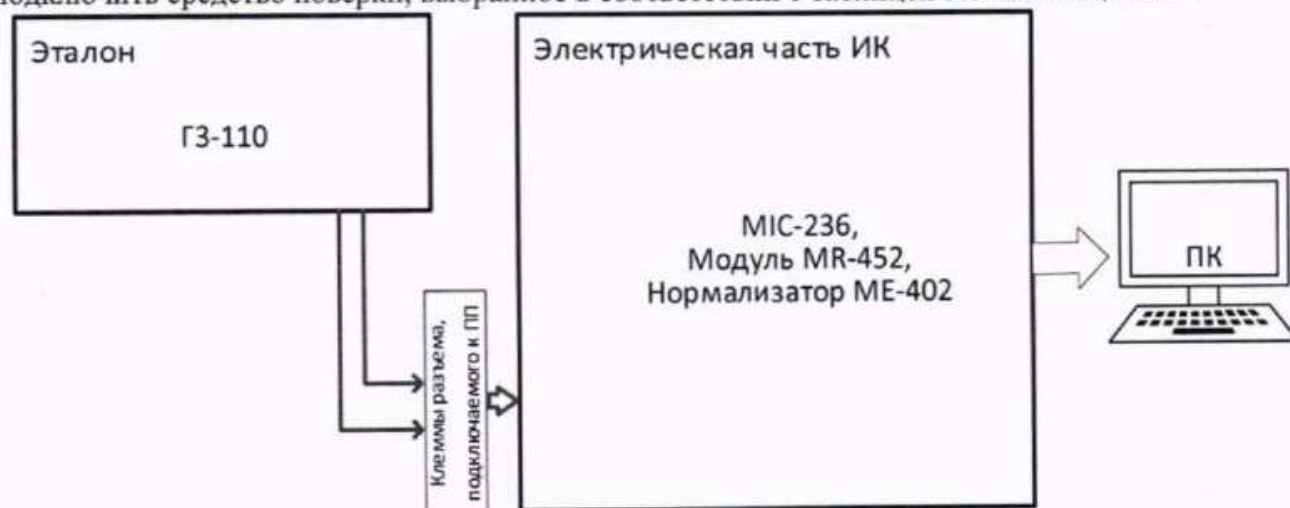
Рисунок 23 – Схема поверки ИК частоты (сигналов переменного тока, соответствующих частоте вращения ротора)
