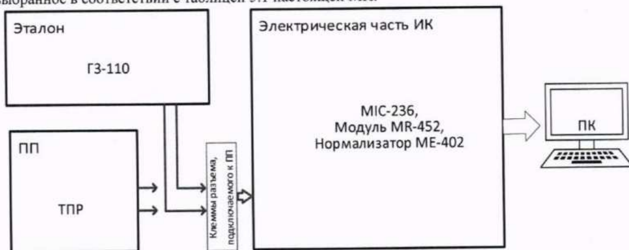
Рисунок 25 – Схема поверки ИК объемного расхода (прокачки) гидравлической жидкости в линии нагнетания
