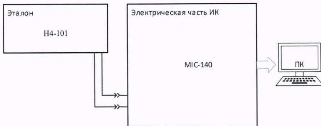
Рисунок 18 – Схема поверки напряжения постоянного тока, соответствующего температуре
