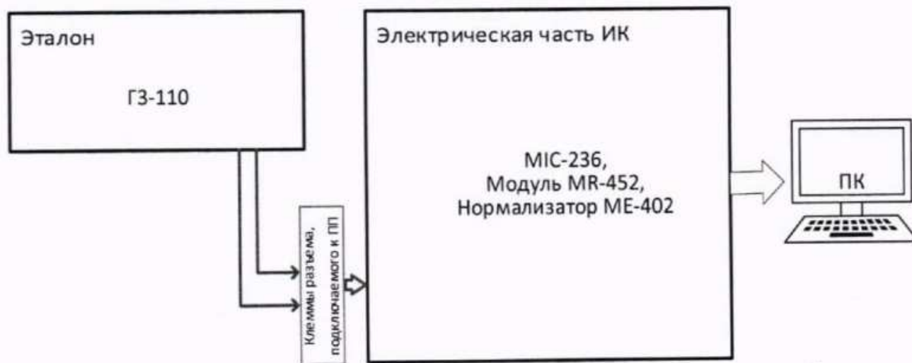
Рисунок 24 – Схема поверки ИК частоты переменного тока генератора
