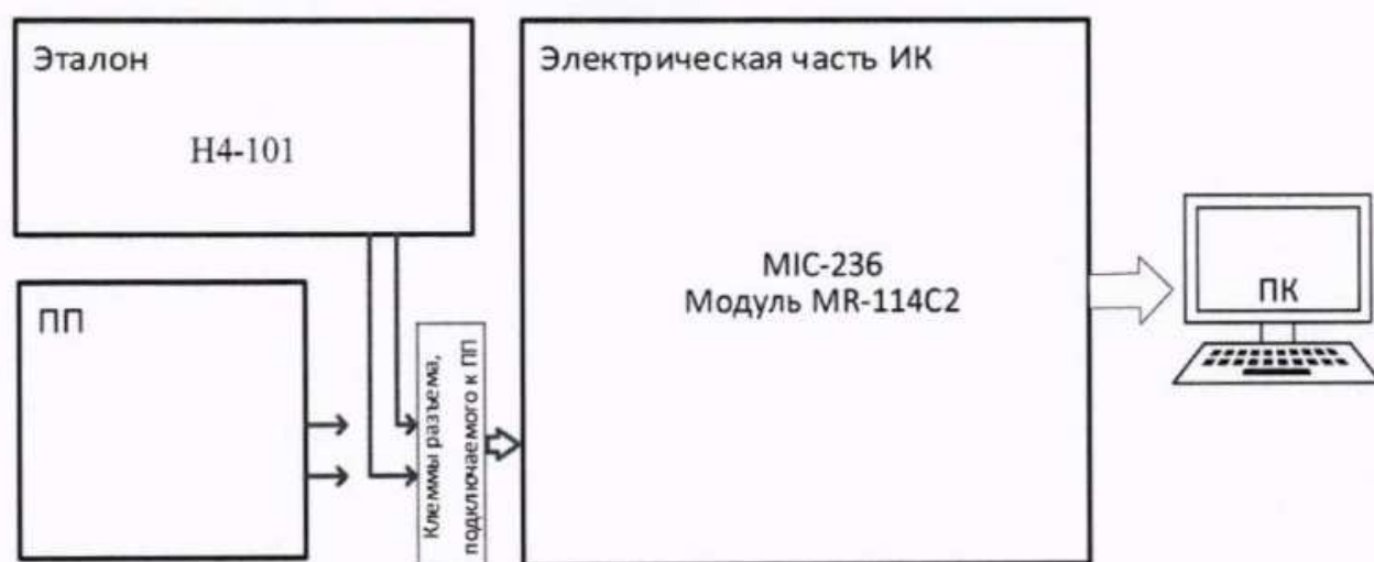
Рисунок 26 – Схема поверки ИК объемного расход масла
