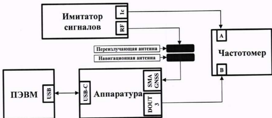
Рисунок 3 – Схема определения инструментальной погрешности синхронизации шкалы времени аппаратуры
