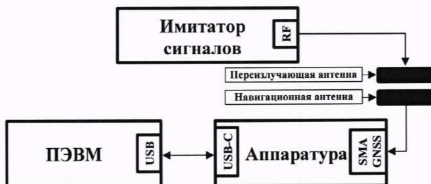
Рисунок 1 – Схема для проведения измерений при опробовании, определения инструментальных погрешностей определения координат местоположения и скорости аппаратуры.
