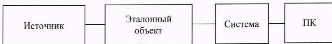
Рисунок 2 – Схема определения абсолютной погрешности измерений линейных размеров
