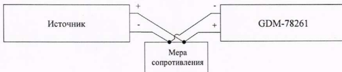
Рисунок 1 – Структурная схема определения относительной погрешности воспроизведения и измерения воспроизводимых значений напряжения и силы постоянного тока
