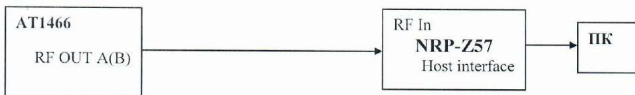
Рисунок 2 – Структурная схема соединения СИ для определения абсолютной погрешности установки уровня мощности выходного синусоидального сигнала
