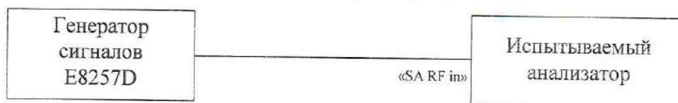
Рисунок 4 – Схема подключения для определения собственного фазового шума анализатора
