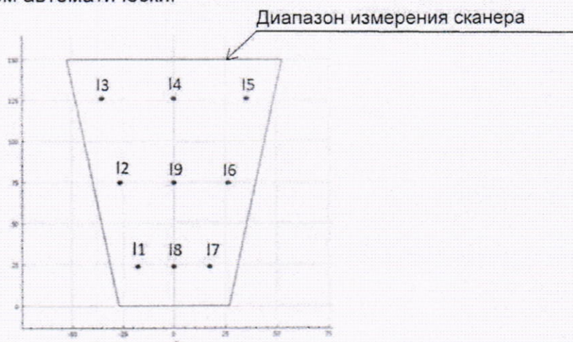
Рисунок 1 — Контрольные точки при измерении размера малых шаблонов
