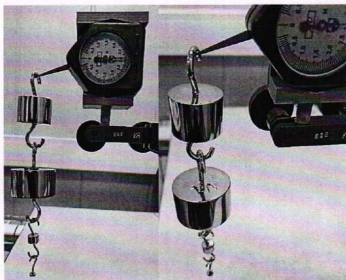
Рисунок 2 – Способ крепления эталонных гирь на конце щупа граммометра
