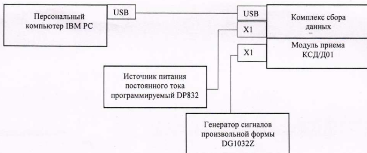
Рисунок 1 – Схема подключений для опробования, определения относительной погрешности измерений частоты переменного тока (положительного и отрицательного фронта), абсолютной и относительной погрешности измерений периода и длительности импульса (положительного и отрицательного фронта)
