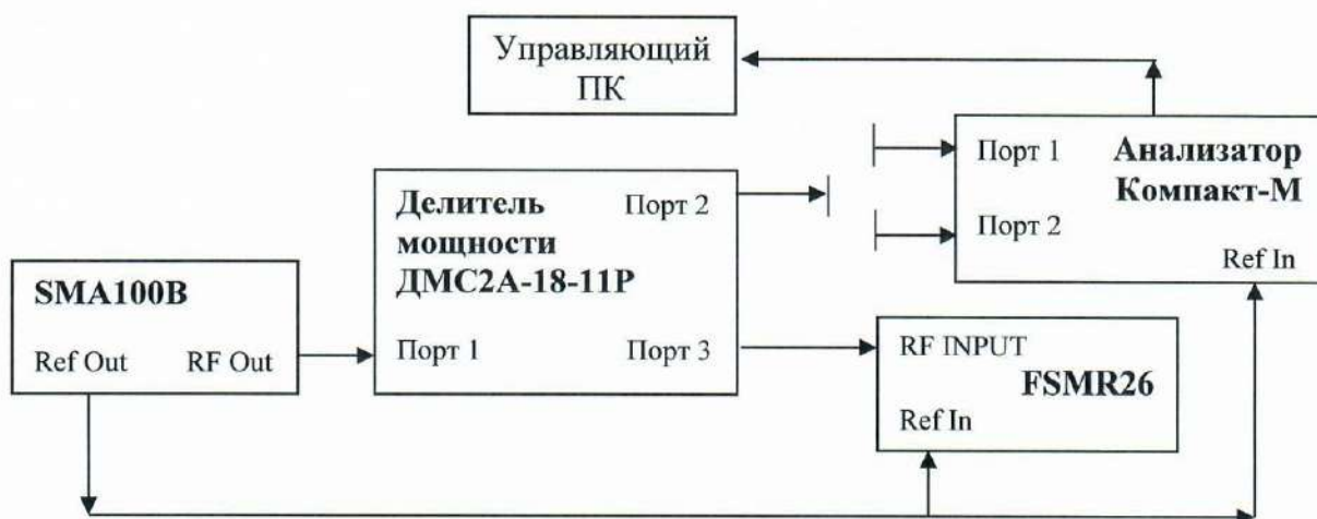
Рисунок 2 – Структурная схема соединения СИ для определения нелинейности приемников
