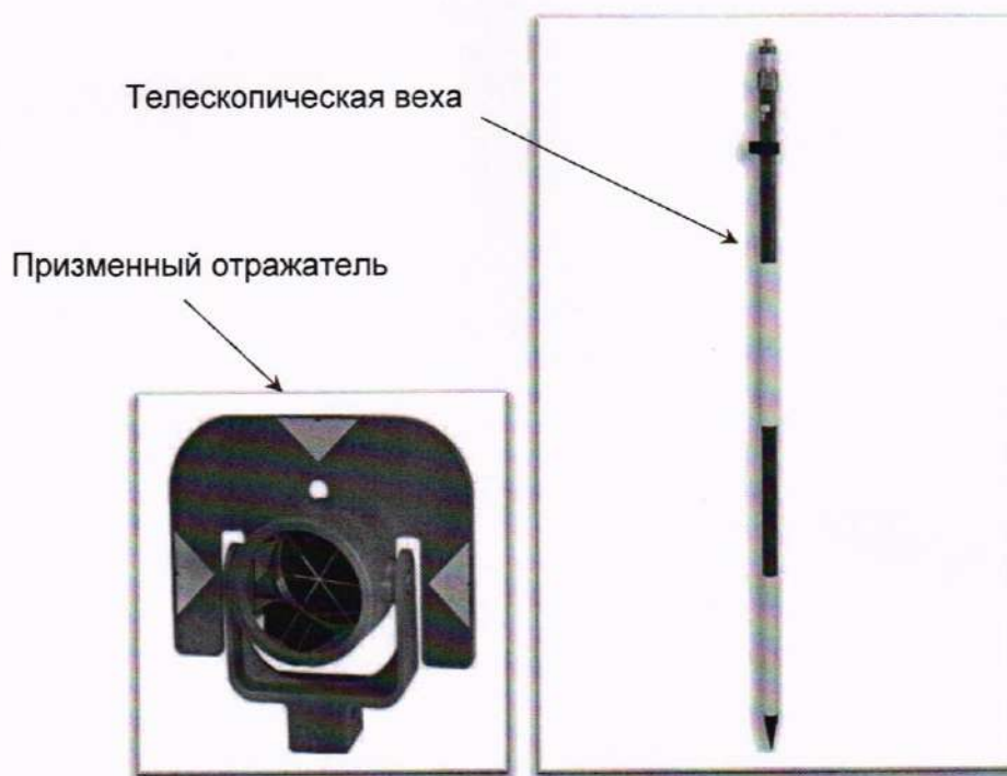
Рисунок А.1 – Вежа телескопическая с призмным отражателем
