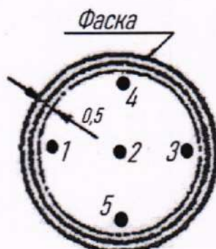
Рисунок 2 – Определение отклонения длины установочных мер от номинального размера
