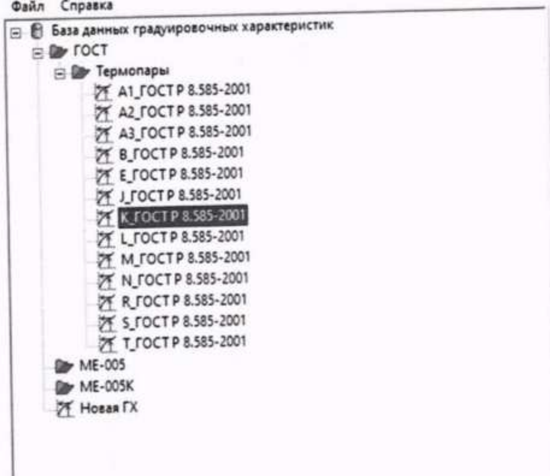
Рисунок Д6 – Окно выбора градуировочной характеристики, соответствующей типу подключаемой к каналу МІС-140 термопары
