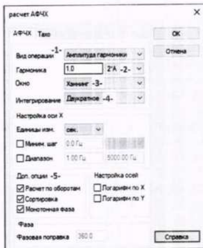
Рисунок 1 - Окно настроек алгоритма АФЧХ для расчета виброперемещений.
