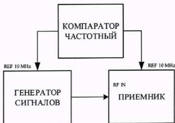
Рисунок 4 – Структурная схема соединения для определения минимальной ширины полосы пропускания измерительного фильтра
