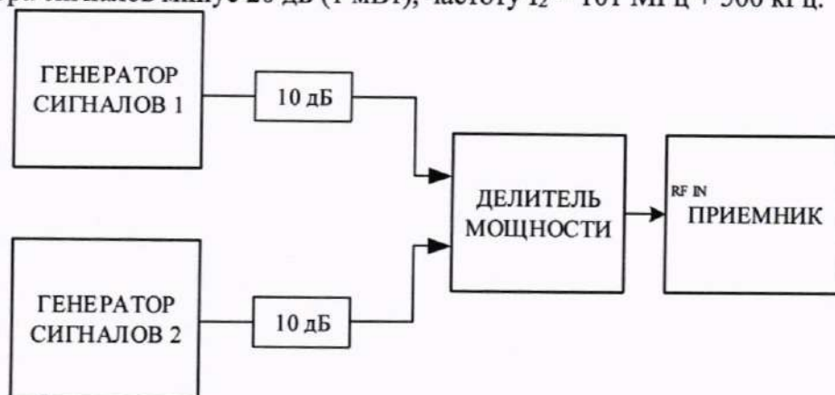
Рисунок 3 – Структурная схема для определения относительного уровня интермодуляционных искажений 3-го порядка в диапазоне частот
