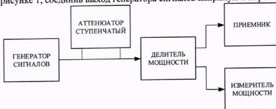
Рисунок 1 – Схема для определения абсолютной погрешности измерений уровня мощности входного сигнала
