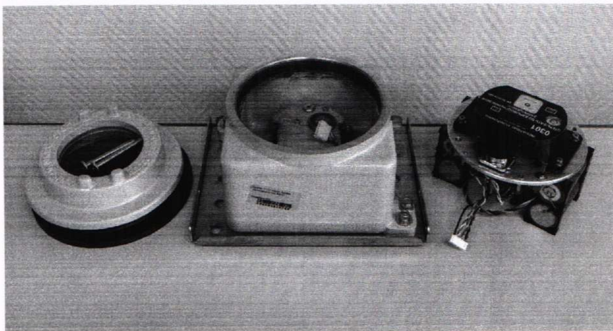
Рисунок 3. Виброскоп DR-24 исполнение DR-24 Ex. Вид после извлечения блока электроники из корпуса
