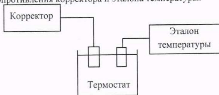
Рисунок 2 – Схема определения относительной погрешности измерения температуры
