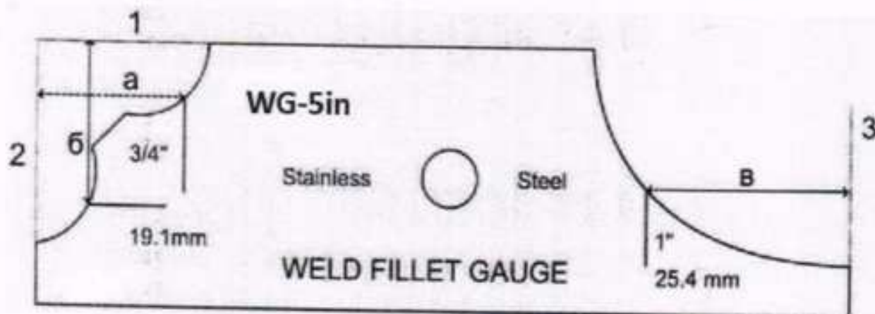
Рисунок 4 – Определение толщины и катета углового шва
