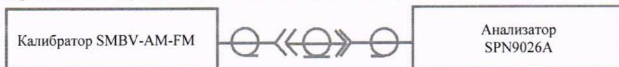
Рисунок 3 – Схема проверки диапазона измерений и определение абсолютной погрешности измерений коэффициентов амплитудной модуляции
