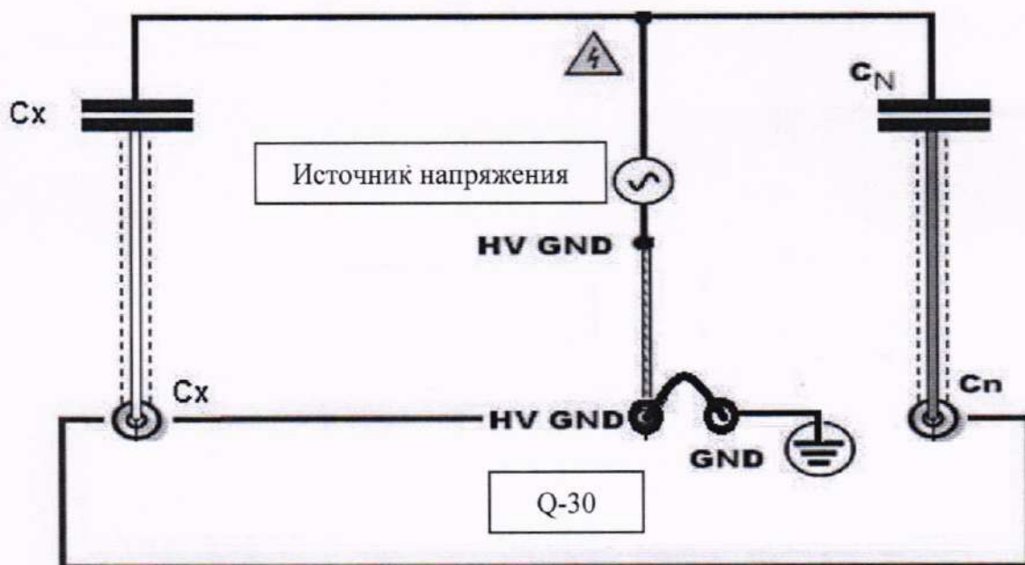
Рисунок 2 – Схема проверки абсолютной погрешности измерений электрической емкости и тангенса угла потерь
