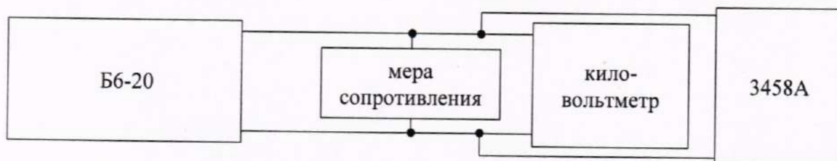
Рисунок 1 – Структурная схема определения относительной погрешности воспроизведений и измерений воспроизводимых значений напряжения и измерений силы постоянного тока (значения напряжения постоянного тока от 5 до 100 В включительно)
