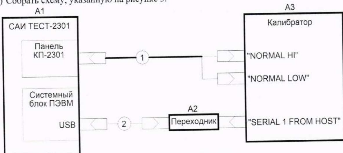
A1 – система автоматизированная измерительная ТЕСТ-2301
