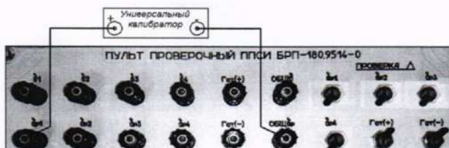
Рисунок 49 – Схема проверки при измерениях системой напряжения постоянного тока
