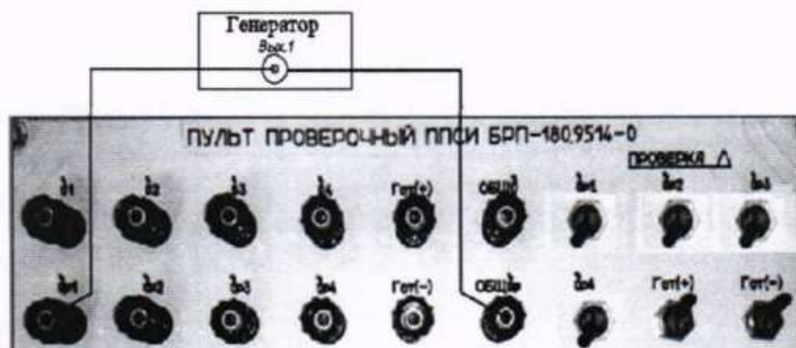
Рисунок 53 – Схема измерений скорости изменения напряжений
