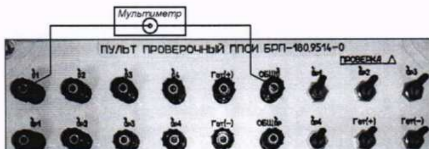
Рисунок 51 – Схема проверки при воспроизведении системой напряжения постоянного тока
