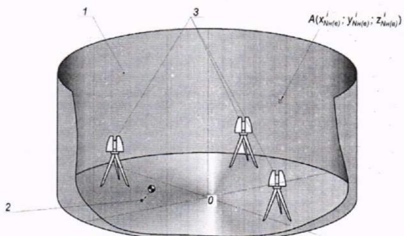
1 – внутренняя полость резервуара; 2 – точка установки сферической марки в точке касания
