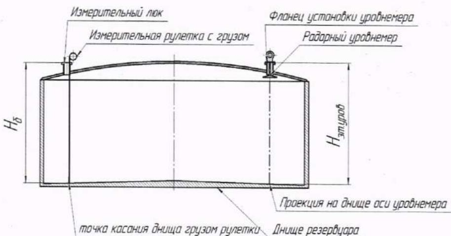
Рисунок А.1 – Схема измерения базовой высоты резервуара и эталонного расстояния
