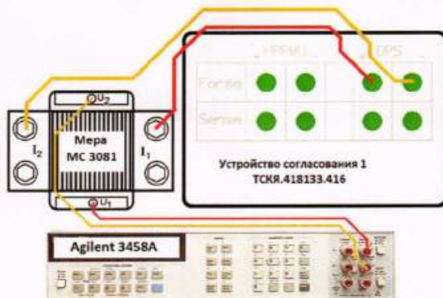
Рисунок 28 – Схема определения погрешности ограничения силы тока группой каналов источника питания DCS DPS128
