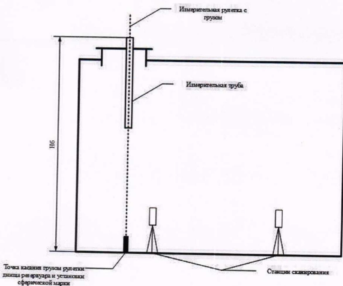
Рисунок А.1. Схема сканирования внутренней полости резервуара
