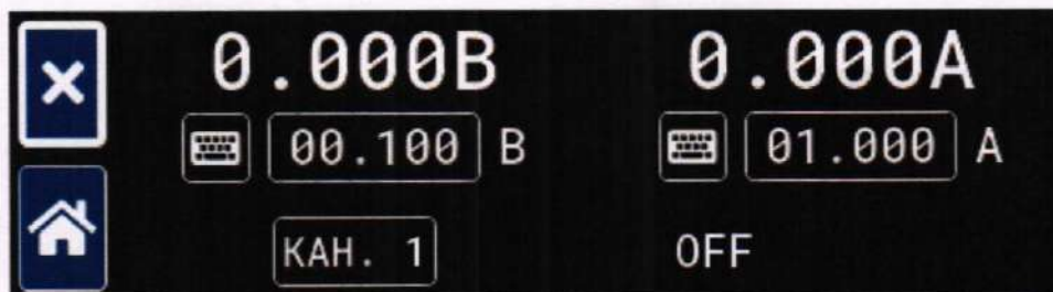
Рисунок 10.1.2 – Для модуля питания, установленного в первом слоте, заданы: напряжение на выходе – 0,1 В, ограничение тока – 1 А
