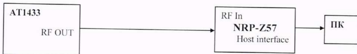
Рисунок 2 – Структурная схема соединения СИ для определения абсолютной погрешности установки уровня мощности выходного синусоидального сигнала
