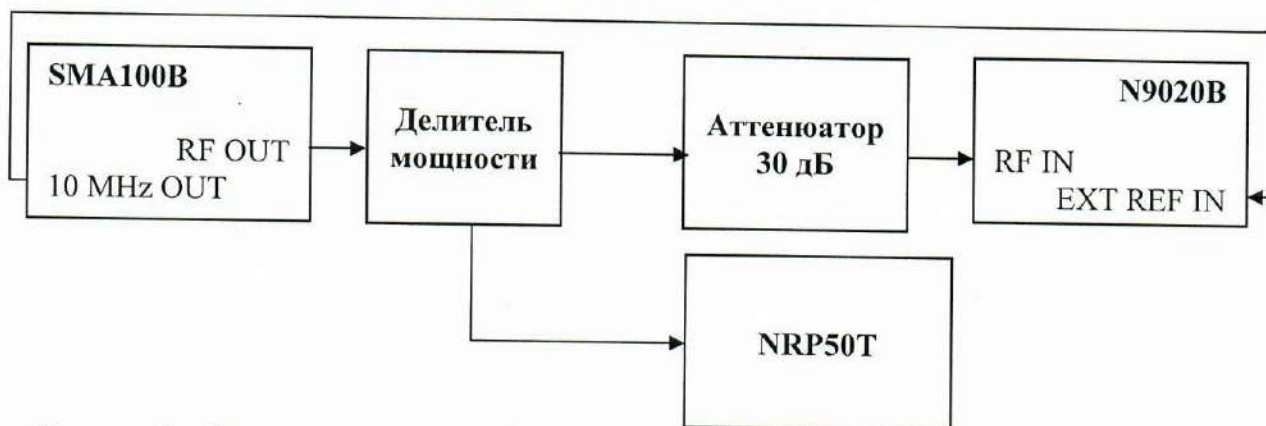
Рисунок 3 – Схема определения неравномерности АЧХ с включенным предусилителем
