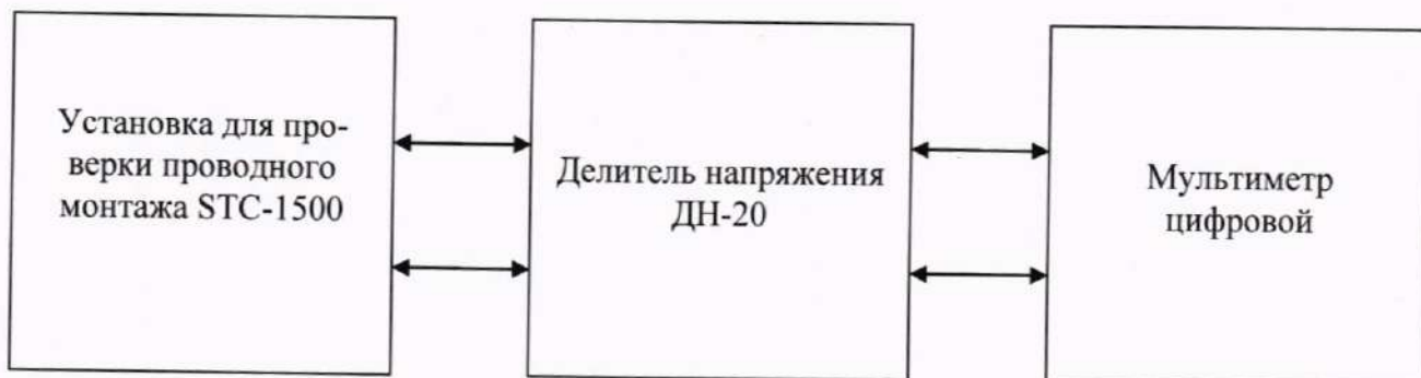
Рисунок 6 - Схема структурная определения относительной погрешности воспроизведений напряжения постоянного тока для напряжения свыше 1000 В.
