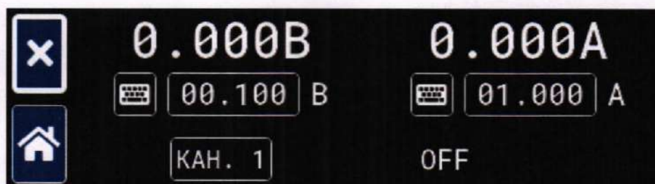
Рисунок А.1 – Для модуля питания, установленного в первом слоте, заданы: напряжение на выходе – 0,1 В, ограничение тока – 1 А
