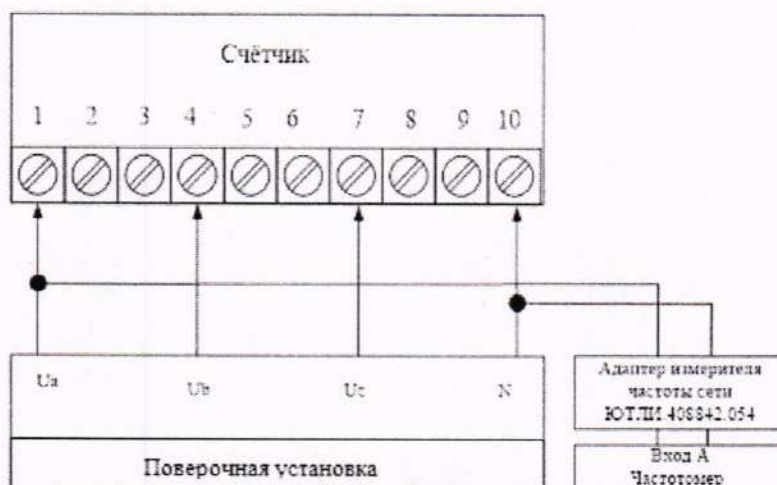
Рисунок 2 – Схема определения абсолютной погрешности частоты сети с применением частотомера
