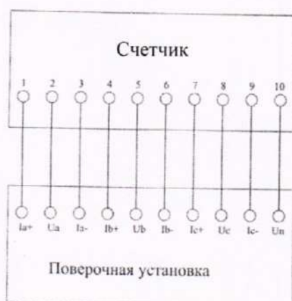
Рисунок 1 – Схема подключения счетчика к поверочной установке
