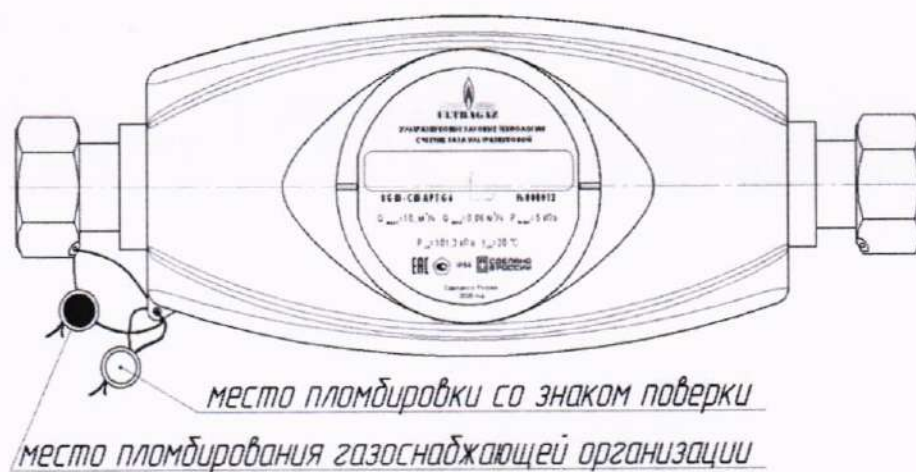
Рисунок А.1 – Схема пломбировки счетчиков
